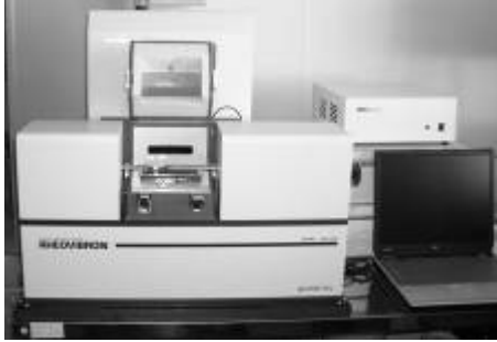
図1 動的粘弾性測定装置（レオバイブロン DDV - 25FP-W）（本科研費で購入）
