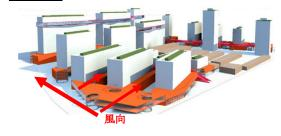
■建物の排熱を意図して水平・鉛直方向に設置した風筒のイメージ図と設置箇所
