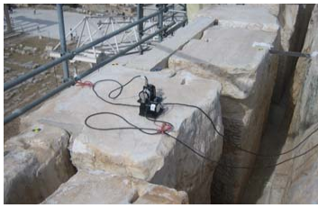
写真3 パルテノン神殿における常時微動測定
