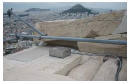
写真 2 パルテノン神殿に設置した地震計
