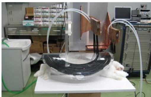
図10. 平面型コイルを用いた試作装置と動物実験の様子
