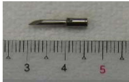
図 5. 本研究で試作した臨床用チタン被覆磁性体針の外観
