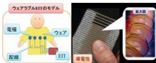
図 1 ウェアラブル EIT 測定ウェアと導電性布電極
