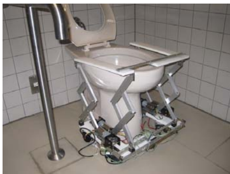
図12 便器の周りを囲んだ移動ロボット
