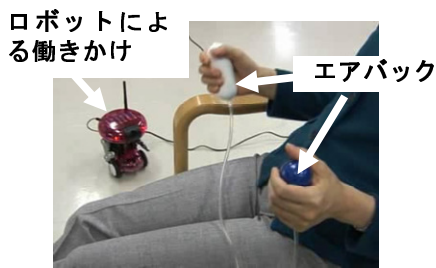
図 6 運動開始を働きかけるロボットとエアバッグを用いたハンドグリップ
