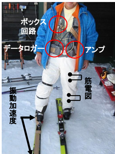
図 1: スキー実滑走時計測の構成
