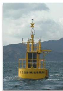
写真 1 GPS ブイ (GPS 波浪計) (港湾空港技術研究所 HP より)
