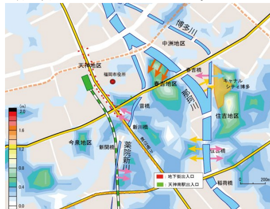
図-1 9時00分における天神地区の浸水深分布 (矢印：河川からの氾濫地点)
