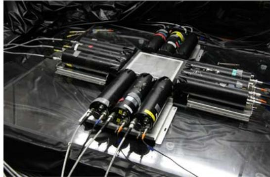
図の中央に配置されている四角の黒枠はアクリルのフレームである。検出器の薄い側の 4 面から蛍光を取り出して測定した。
