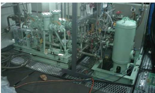
図5 ヘリウムガス循環装置
