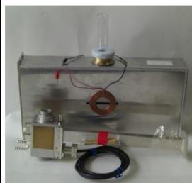
図6 手前 X-band ユニバーサル共振器 (JEOL 製の改造品) と後方は L-band 矩形共振器(何れも ESR スペクトルを計測済み)
