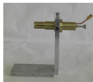
図4 L-band 試料接触型同軸共振器
