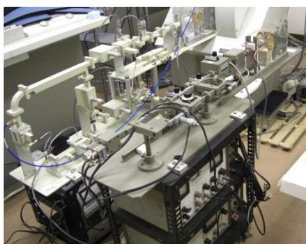
図1 新規試作した X-band(左側)と K-band(右側)電磁ホーン型 ESR 装置。写真上部に JEOL 製の電磁石が見える。
