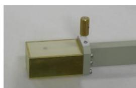
図5 高Q円筒共振器の小穴からの漏洩マイクロ波で ESR 及び ESR イメージングを行う X-band 共振器
