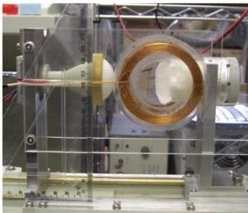
図9 電磁ホーンと反射板間に設置した ESR 用 1 軸ゴニオメータ。大型の as grown 単結晶 ( $\gamma$  線照射 L-アラニン添加硫酸三グリシン；焦電性-高感度赤外線センサー材料) が設置され測定中である。K-band 電磁ホーン型 ESR 装置に設置。 回転角度読取精度  $1^\circ$
