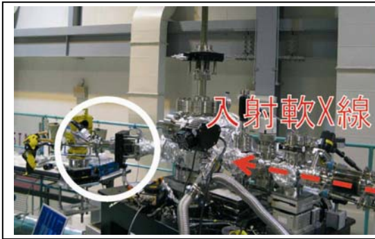
図2. SPring-8の軟X線ビームラインBL25SU(軟X線固体分光)での実験の様子。白丸の中が、我々が開発した小型の軟X線用高速APD測定器システムのセンサーと主要な部分。図の右側から軟X線が入射し、ターゲットで散乱した軟X線をこの軟X線用高速APD測定器システムで受ける。超高真空中( <1 \times 10^{-7} Pa)での実験。
