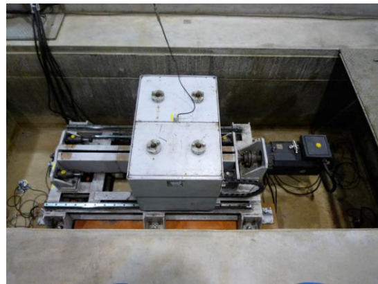
図3. 水平加振型低周波震源装置
