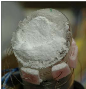
図 4 粉碎した石英単結晶試料
