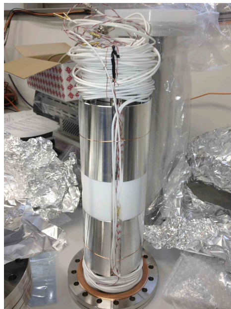
図2 検出器の写真。図1のセットアップは真空容器に封入される。
