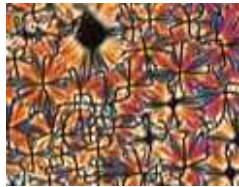
図3 LCD1-PN の光学組織 (115°)
