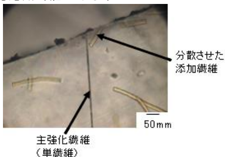
図1 添加繊維が主繊維付近に生じる損傷き裂の進展を抑制したモデル実験の例。
