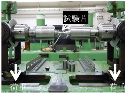
図3 回転曲げ疲労試験機
