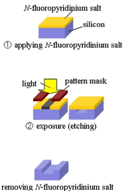
図 1 N -フルオロピリジニウム塩を用いた光エッチング工程
