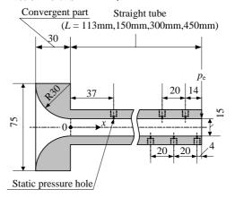
流れがチョークするときの圧力比,すなわちチョーク圧力比( $\rho_{c}/\rho_{o}$ )。は,一次元定常等エントロピー流れの理論値より小さく,ノズル出口の境界層厚さが厚いほど小さい.すなわち,チョーク圧力比は境界層によって顕著に影響を受ける.
