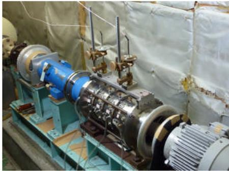
図1 過渡現象研究用軸流圧縮機
