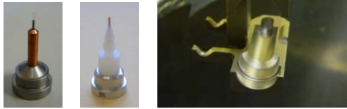
図1. ホルダーとロボットハンド先端 (左: ハンプトンリサーチ社のホルダー、中: SPACE用ホルダー、右: 製作したロボットハンドの先端部)
