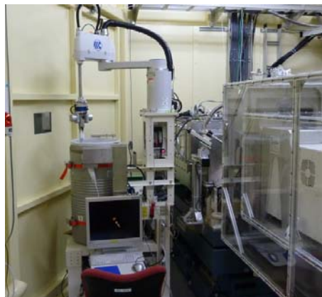
図2. フォトンファクトリー放射光研究施設BL-1Aに設置している4軸水平多関節ロボット
