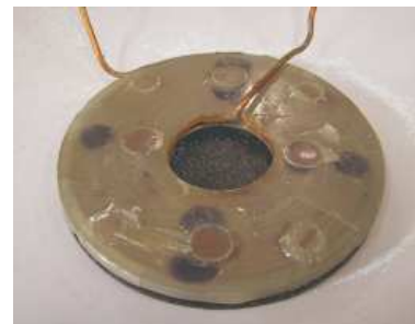
図1 Bi2223 円板を用いたディスク型超伝導限流器の小型モデル
