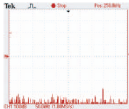
図6: PCM4202EVMを用いた試作基板において観測された出力電圧の周波数特性(出典:学会発表②Fig.7C)
