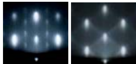
図3. GaAs基板上のCuInS 2 薄膜(厚さ0.14μm)で、基板の<100>(左図)及び<110>(右図)の方向へ電子線入射したときのRHEEDパターン。c軸方向に成長したカルコパイライト構造の薄膜のパターンとして解釈可能。
