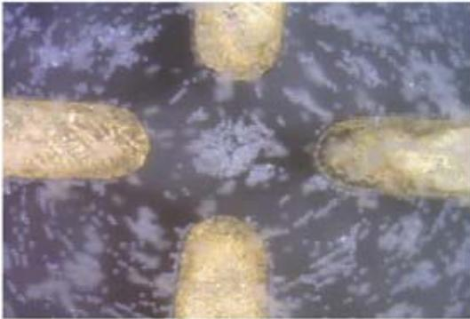
図2 四重極電極におけるパルス駆動誘電泳動
