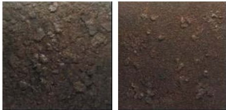
写真 6 さびサンプル携帯版 (左: 評点 2、右: 評点 3)
