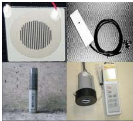
写真 3 ACM センサー、温湿度センサー、USB 型温湿度計、表面塩分計
