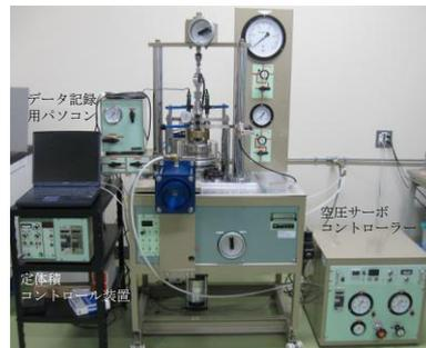
図-2 繰返しリングせん断試験装置(全体)
