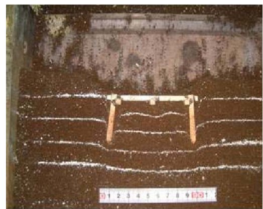
図-2 基礎模型の沈下状況及び地盤変形状況
