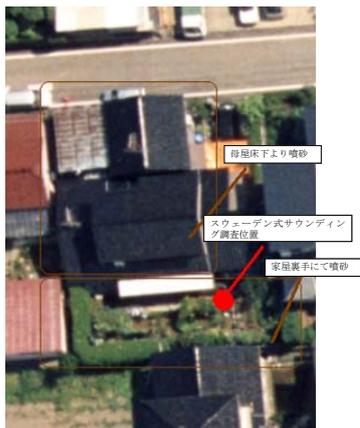
写真一3 液状化被害調査と地盤のサウンディング調査事例
