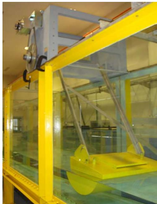
写真3 現地用浮体型波力水車
