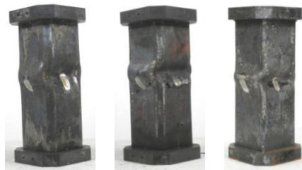
写真2 実験後の短柱試験体（加熱後常温時）
