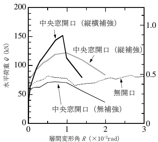
a) 中央窓開口試験体と無開口試験体
