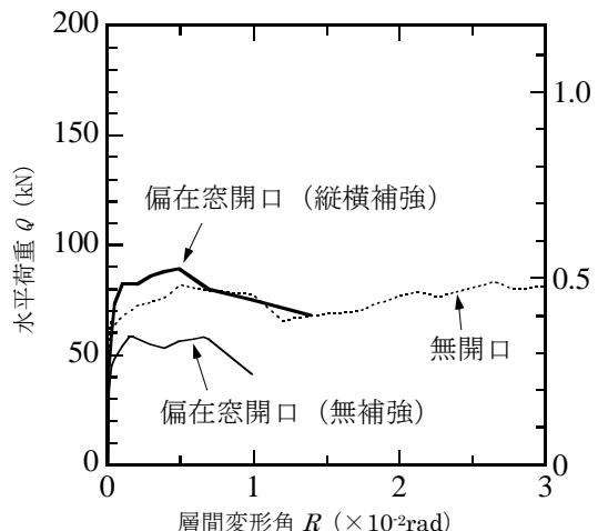
b) 偏在窓開口試験体と無開口試験体
