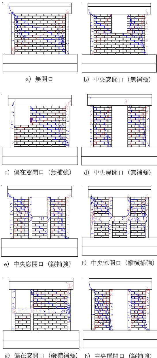
図2 西面のひび割れ状況
