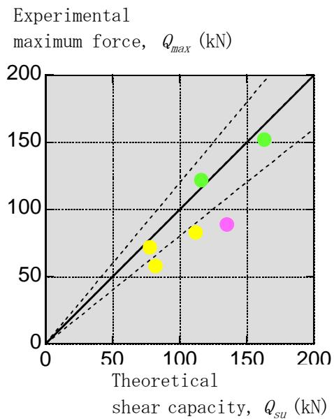
図4 最大荷重実験値  $Q_{max}$  とせん断強度計算値  $Q_{su}$  の関係
