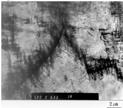
図10に Solution-treated の700°Cにおける圧縮ひずみ保持台形波低サイクル疲労破断材（ひずみ範囲0.4%、 N_{25}=6.54 \times 10^3 ）の微細組織
