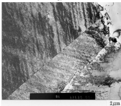
図12 As-receivedの700°Cにおける対称三角波低サイクル疲労破断材（ひずみ範囲0.4%、 N_{25}=2.28 \times 10^5 ）の粒界近傍の微細組織。
