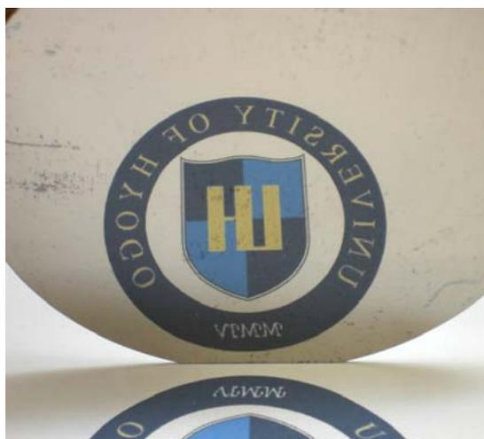
図3 本方法でニッケルめっき膜をつけたシリコンウェーハ(直径100 mmのウェーハ全面に金属光沢を持つ薄膜が均一に形成され、兵庫県立大学の学章が鮮やかに映っている)
