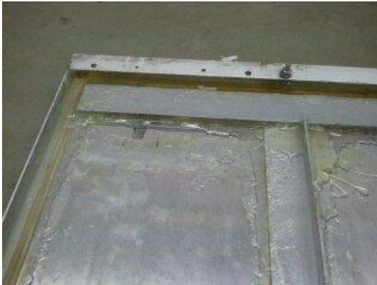
図 11 冷却パネル(改良型の接着部)
