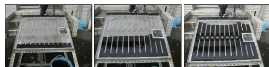
図3 冷却パネル内の冷却可視実験
