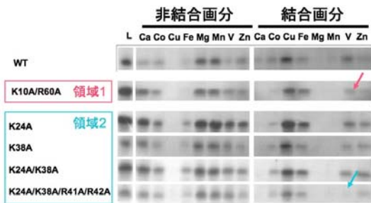
図 2. Vanabin2 変異体の金属結合能(IMAC 解析の結果)。
