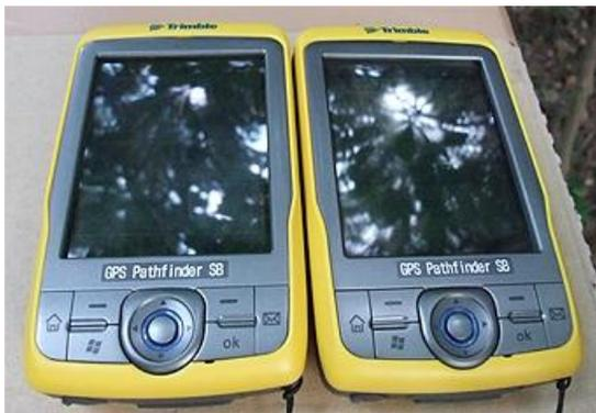
図-10 2 台の GPS 受信機を並べて行った MSAS の測位試験
