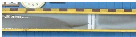
図-1 堰上下流で連続する砂礫堆
