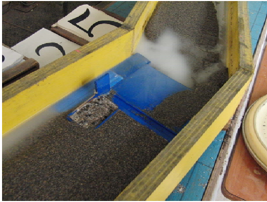
図-6 引き込み式魚道の模型実験 (寒河江川昭和堰の現況再現)
