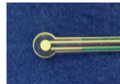
図 1：本研究において用いたシート型センサ
