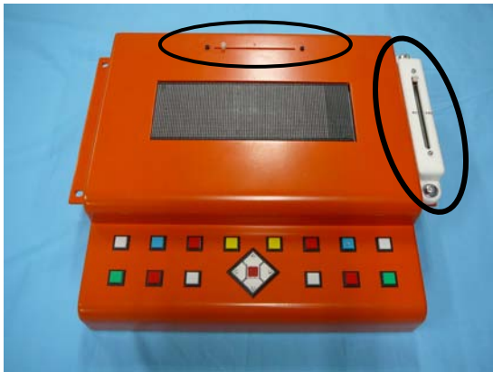
図1 インタラクティブ型触覚ディスプレイ (黒枠の部分は触覚スクロールバー)
