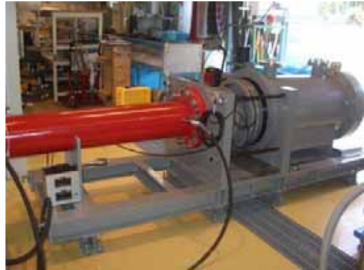
写真-1 高圧脱水固化装置 (最大載荷力 2MN) 供試体寸法：直径 0.53m x 長さ 1.0m
