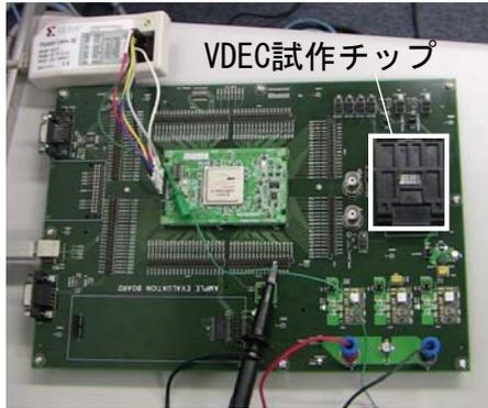
また、消費電力の実測とシミュレーションによる実験により試作チップの消費エネルギーと性能を評価した。消費電力を1/3倍まで動的にスケールできることをシミュレーションと実測により確認した。消費電力の動的スケール（変更）は約1 $\mu$ 秒で行うことができ、既存手法に比べて2桁の高速化を実現した。下図に実測（折れ線グラフ）とシミュレーションによる見積り結果（棒グラフ）を示す。
