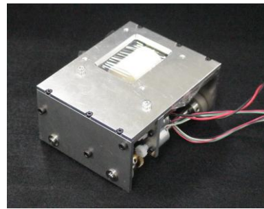
図4 フィルムと回転体を用いた滑り感覚ディスプレイ
