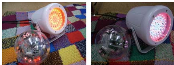
図6 LED照明を制御する応用例. カメレオンボールに同調して照明の色や明るさが変化する。
