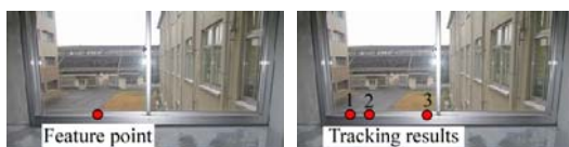
(a) 時刻 t (b) 時刻 t+1 図 2 誤追跡しやすい偽の特徴点の例
