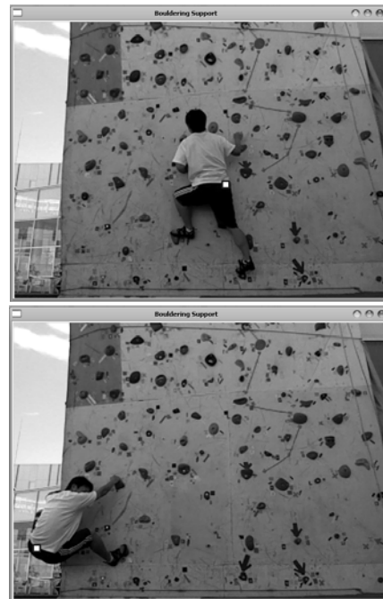
図 3 オプティカルフローを用いたボルダリング時の腰部の位置追跡
