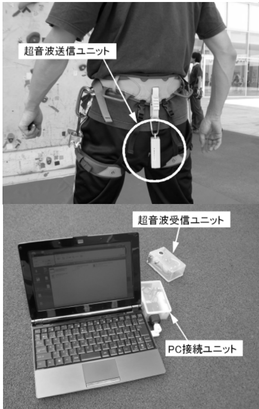
図 2 腰部の超音波送信ユニット(上)と地上の PC・受信ユニット(下)
