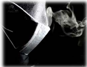
図3 マスク装着時の白煙漏れ挙動
